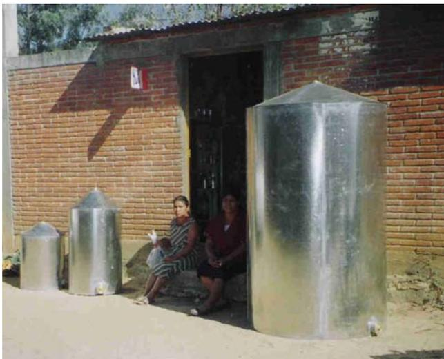
Figura 1. Silos metálicos empleados para almacenar maíz en algunas regiones de los Valles Centrales de Oaxaca. De izquierda a derecha se muestran los de 100, 200 y 1000 kg de capacidad.
